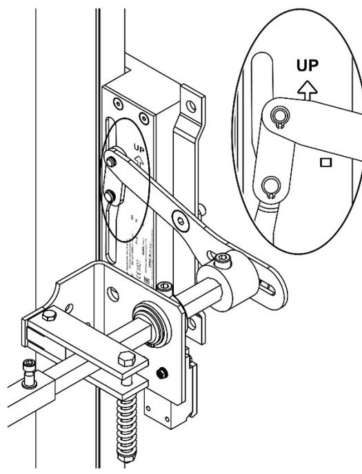
Figura 6: Posición del paracaídas en guías invertidas
