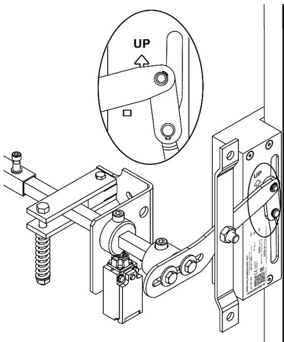
Figura 5: Posición del paracaídas
