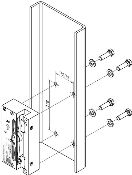
Figura 2: Montaje paracaídas en el chasis (1)
