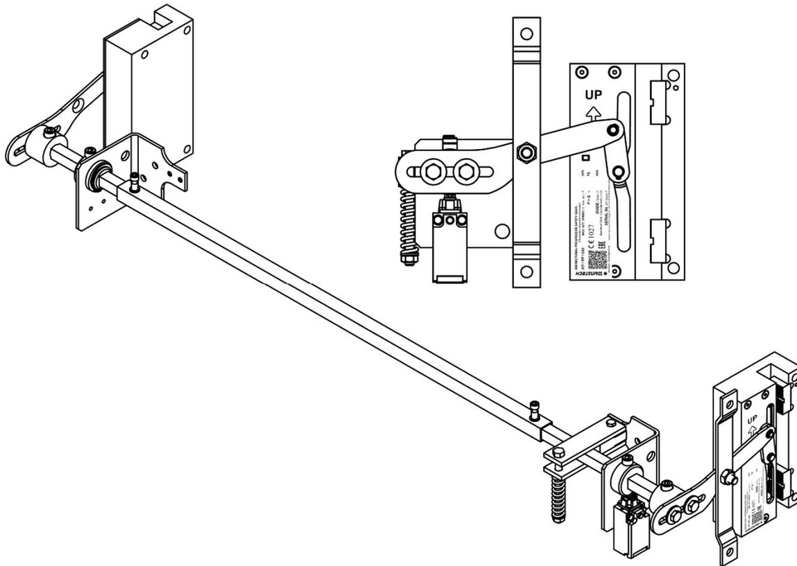
Figura 9: Sincronización de los paracaídas mediante la timonería T-3
