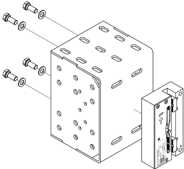
Figura 3: Montaje paracaídas en el chasis (2)
