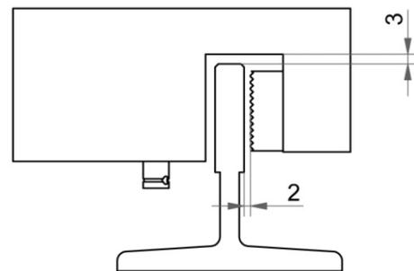
Figura 8: Ajuste del paracaídas respecto a la guía
