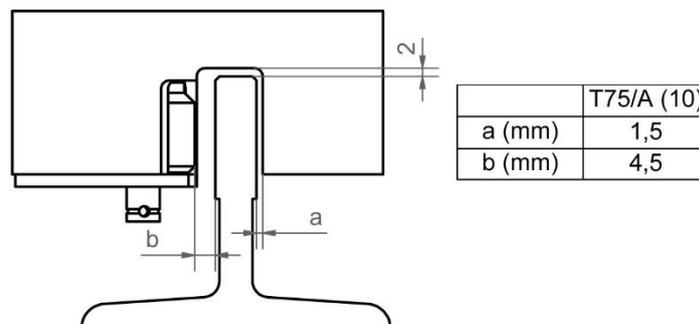
Figura 6: Ajuste del paracaídas respecto a la guía (IN-3000 G10)
