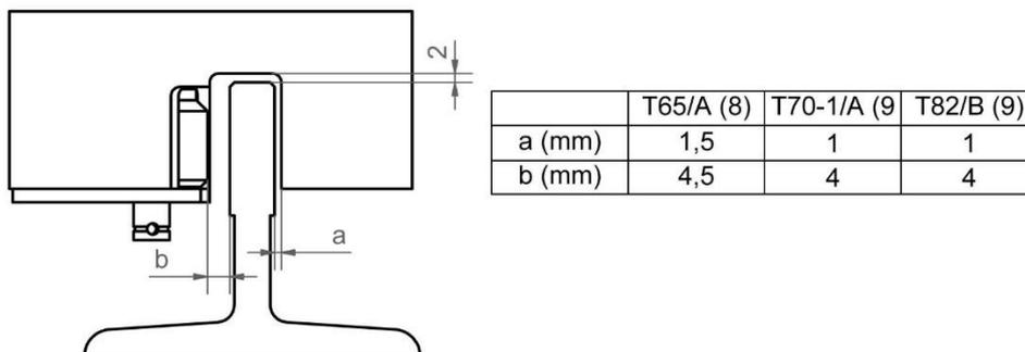
Figura 5: Ajuste del paracaídas respecto a la guía (IN-3000)
