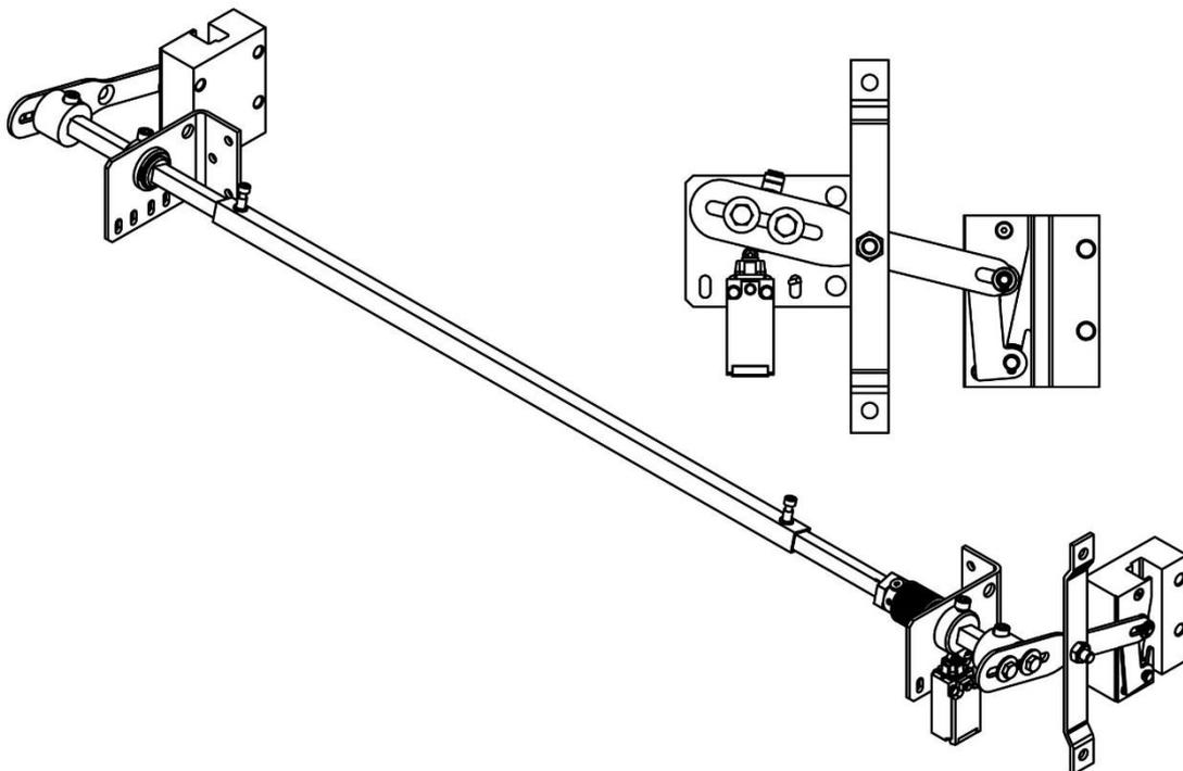
Figura 7: Sincronización de los paracaídas mediante la timonería T-1
