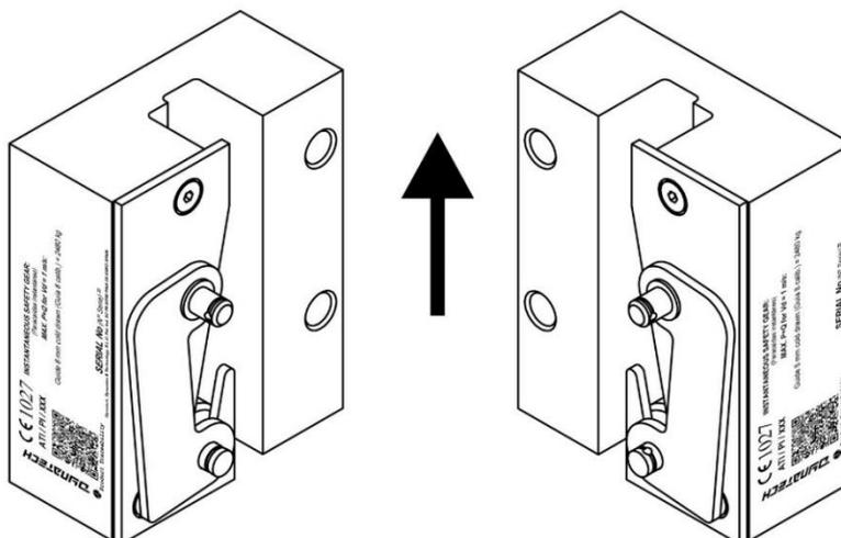
Figura 3: Dirección de la posición del montaje
